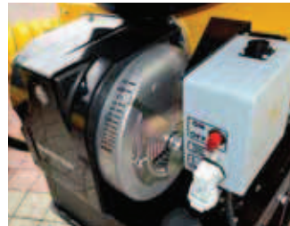
Bedienungsfeld: Ein/Ausschalter, Resettaste, Stecker für Fernthermostat: analog oder digital
