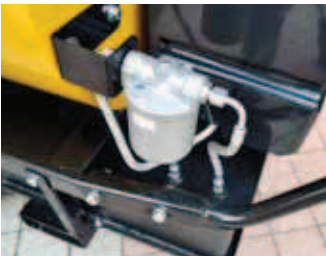
Kraftstofffilter ist aussen. Kraftstoffvorwärmer ist innerhalb der Brennerköpfe
