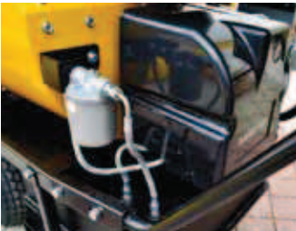
Die Heizung erhält den Kraftstoff aus den darunter befindlichen Tank, kann aber auch über externen Tank arbeiten
