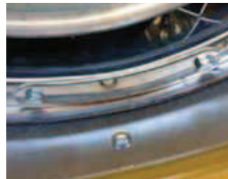
BV 500 hat Öffnungen im Wärmetauscher zur leichten Reinigung
