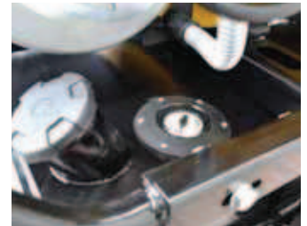
Mit leckfreiem Tankverschluss und Kraftstoffanzeige
