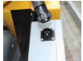
Der Motor ist mit Stecker an der Elektronik angeschlossen und erleichtert den Service
